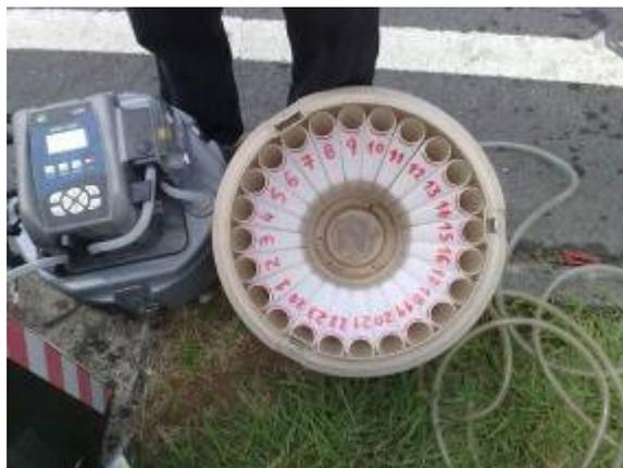
**Figura 7.- Detalle del tomamuestras automático con la unidad de control y la bomba peristáltica de toma de muestras y disposición de las 24 botellas para la toma de muestras.**
